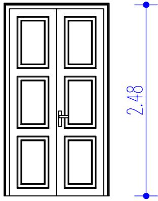
Dvokrilna lesena masivna notranja vrata, izdelana iz smrekovega lesa (bela barva), v lesenem plohestem podboju, v obstoječem zidu, zidna odprtina je velikosti 133 / 248cm. Vrata so izdelana po vzoru primarnih vrat in morajo biti v skladu z ZVKDS.
