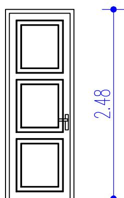
Enokrilna lesena masivna notranja vrata, izdelana iz smrekovega lesa (bela barva), v lesenem plohestem podboju, v obstoječem zidu, zidna odprtina je velikosti 90 / 248cm. Vrata so izdelana po vzoru primarnih vrat in morajo biti v skladu z ZVKDS.
